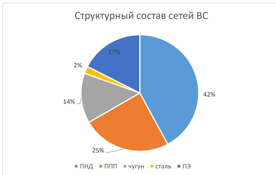
**Рисунок 15 Структурный состав сетей водоснабжения
