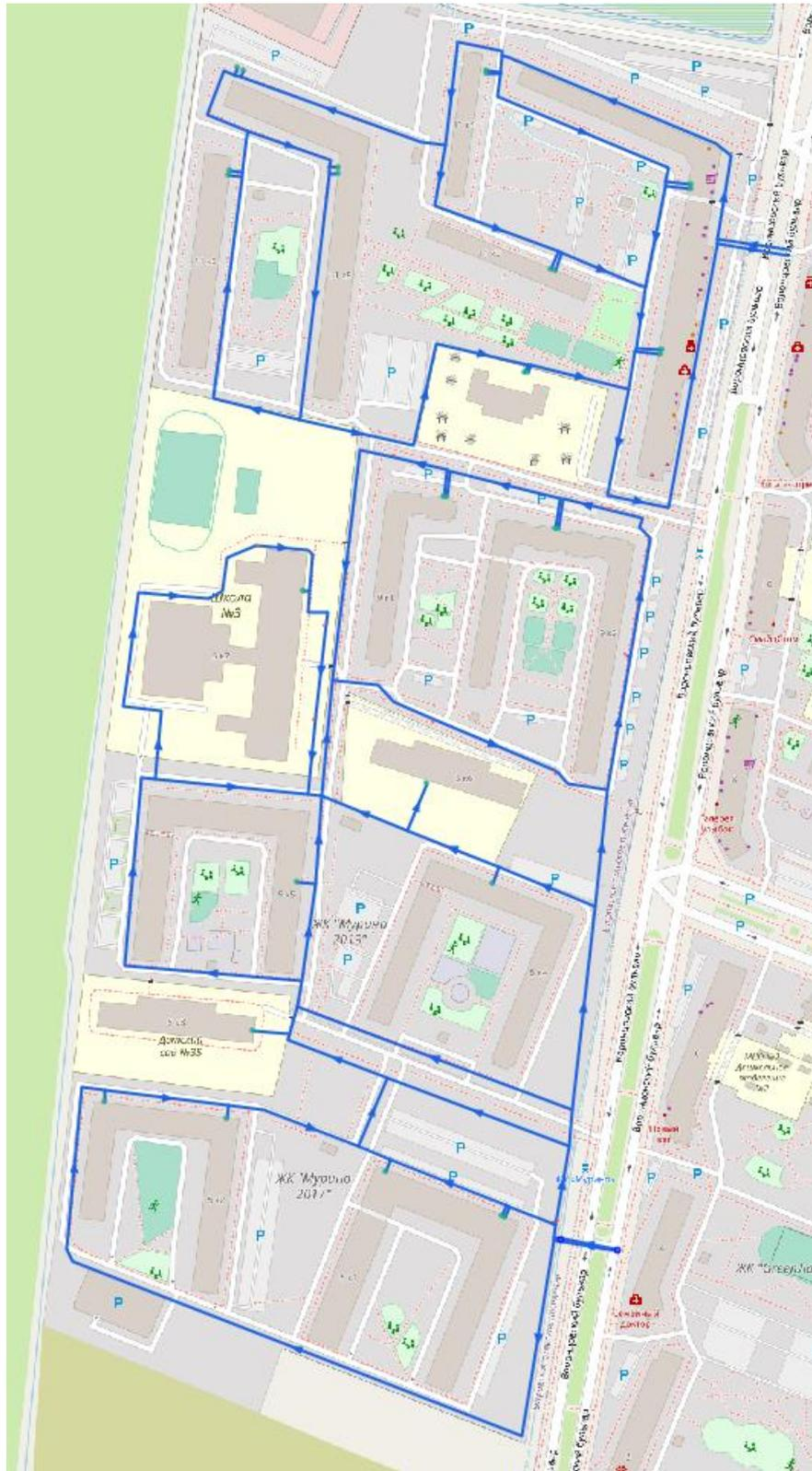
**Рисунок 5** Схема водоснабжения п. Бугры (технологическая зона ВС №2)
