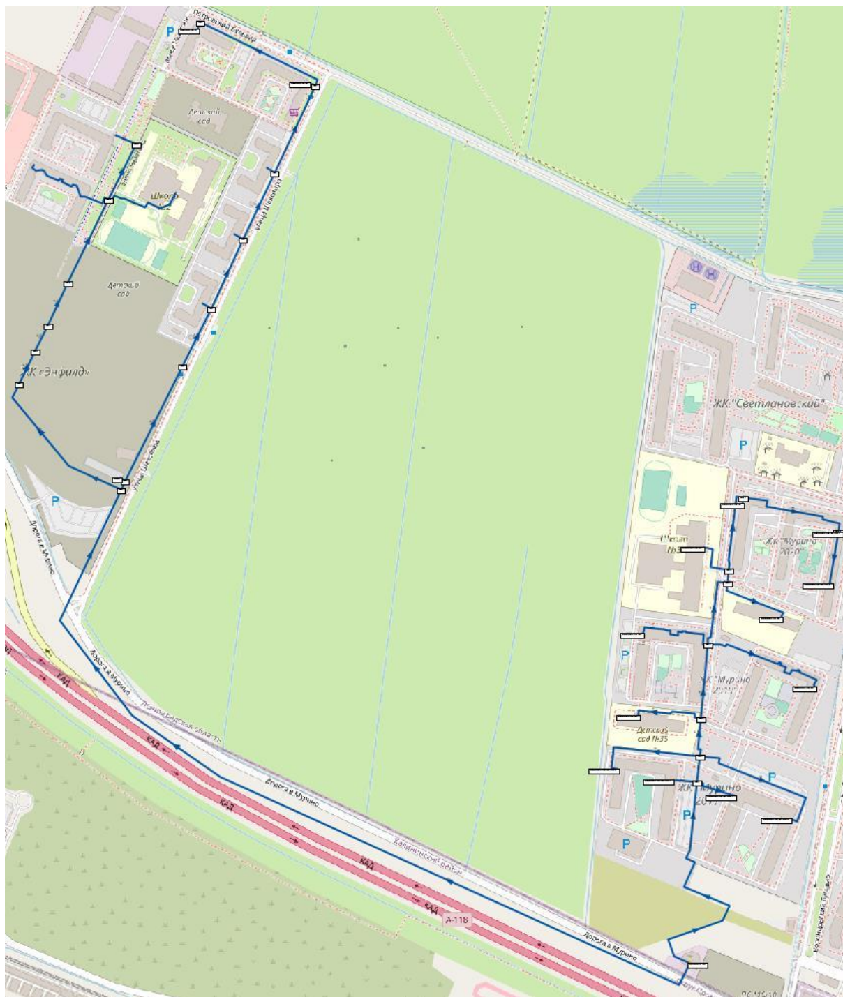
Рисунок 10. Схема тепловых сетей от котельной уч. 978 (зона действия №5), п. Бугры
