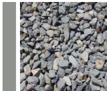
отсыпка из крупного щебня
